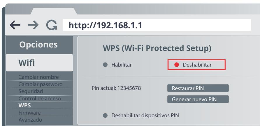
Se trata de un mecanismo que facilita la conexión de dispositivos con nuestro *router* a través de un código PIN<sup>13</sup> de 8 dígitos. El dispositivo que se quiere conectar a la wifi debe transmitir el código numérico al *router* y éste a cambio le enviará los datos para acceder a la red.
