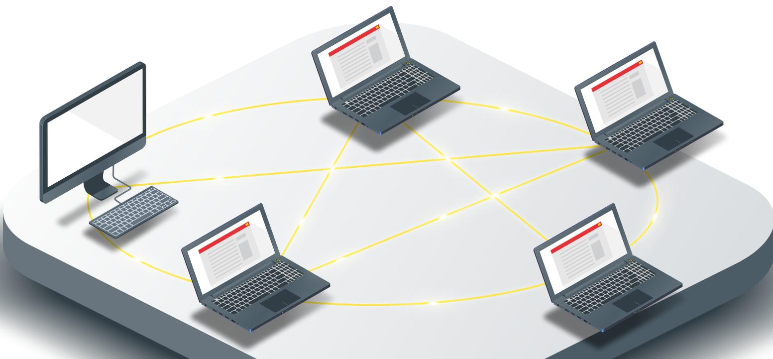
2. *Bluetooth* es una tecnología inalámbrica de radio de corto alcance, cuyo objetivo es eliminar los cables en las conexiones entre dispositivos electrónicos, simplificando así las comunicaciones entre teléfonos móviles, ordenadores, cámaras digitales y otros dispositivos informáticos operando bajo la banda de radio de 2.4 GHz de frecuencia.
