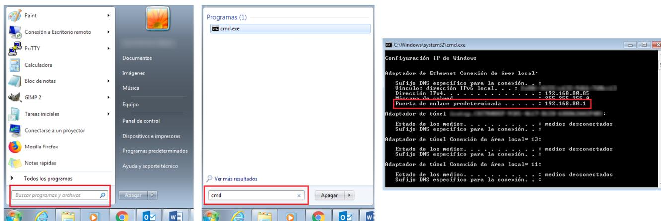
6. Una dirección IP (del acrónimo inglés IP para *Internet Protocol*), es un número único e irrepetible con el cual se identifica a todo sistema conectado a una red.
